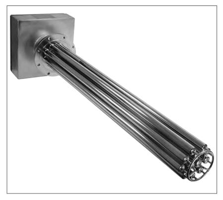
Heizstab wird durch mechanische Expansion verschlossen. Diese totraumarme Variante kommt bei Reinstwasser (z. B. aqua purificata) mit geringeren Anforderungen zum Einsatz.
