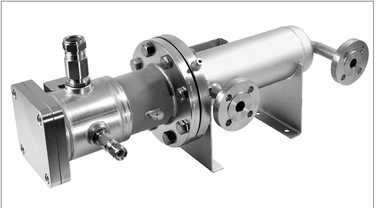
Durchlauferhitzer DN 100 mit explosionsgeschütztem Anschlussgehäuse Ex II 2 G Ex d IIC T4.
