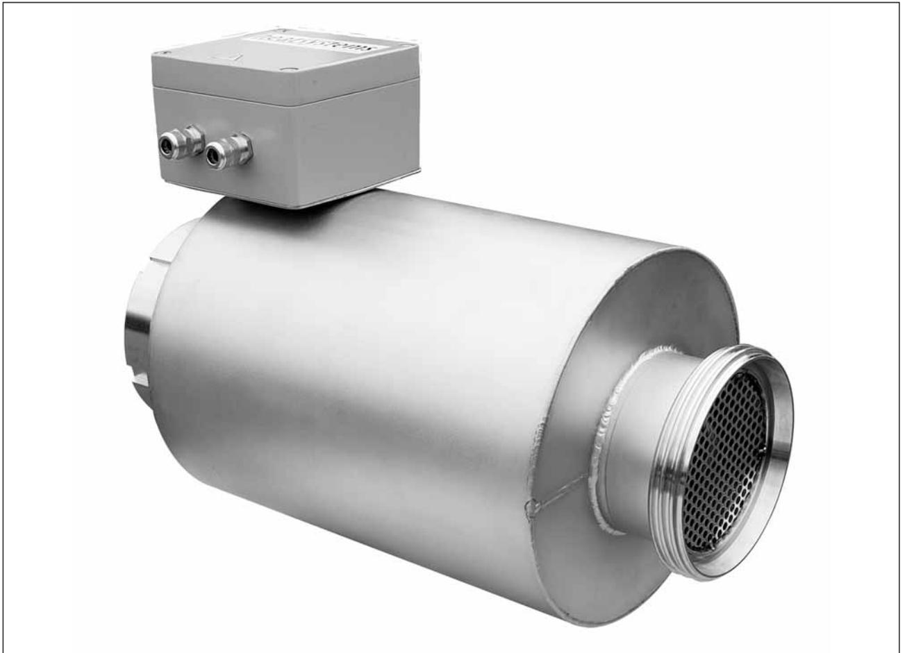
*Rohr-Luftherhitzer 5 kW mit Schutzgitter im Mediumbereich und Schraubanschlüssen für die mediumseitigen Anschlüsse. Mit verschweißter thermischer Isolierung.*
