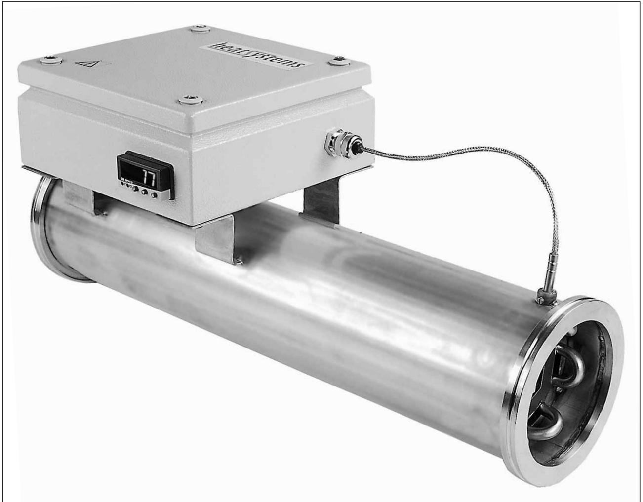
*Rohr-Luftherhitzer mit eingebauter Temperatur-Regelung und -Anzeige. Leistung 4 kW. Zum Einbau in Luftkanal. Versehen mit kundenspezifischen Anschlussflanschen.*
