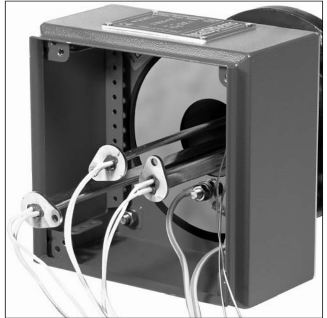
Elektro-Flanschheizkörper mit austauschbaren Ovalrohr-Heizkörpern (das Heizelement kann ausgetauscht werden, ohne das Medium abzulassen).
