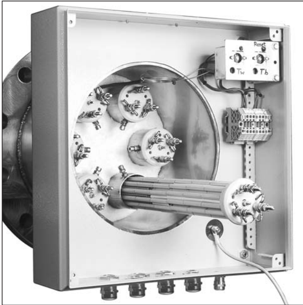
Keramik-Gliederheizkörper mit Edelstahl-Schutzrohr (die Heizpatrone kann ausgetauscht werden, ohne das Medium abzulassen).
