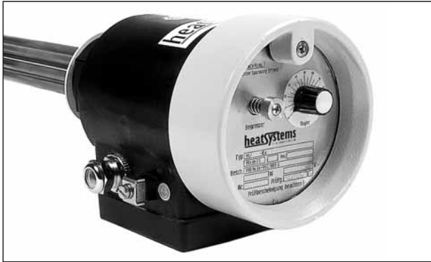
Einschraub-Heizkörper mit explosionsgeschütztem Anschlussgehäuse. Leistung 3,0 kW, Spannung 230 Volt AC. Eingebauter Temperatur-Begrenzer, direkt schaltend verdrahtet. Temperaturklasse T3.
