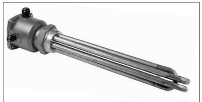
Einschraub-Heizkörper für medizinische Bäder. Heizkörper aus Edelstahl Wst.-Nr. 2.4858 (Incoloy 825), in die Verschraubung 2 1/2" aus Edelstahl Wst.-Nr. 1.4571 (316Ti) eingeschweißt.
