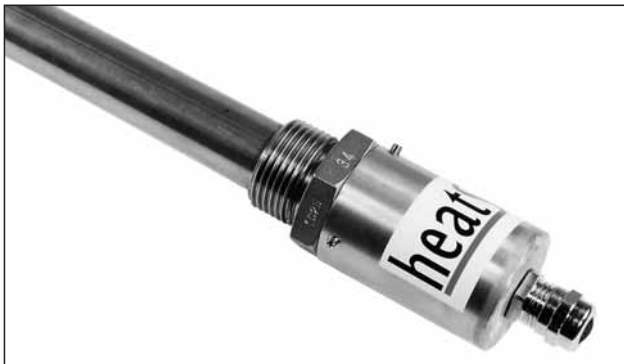
Einschraub-Heizpatrone. Leistung 2,2 kW, Gewinde 1", Kabelverschraubung axial.
