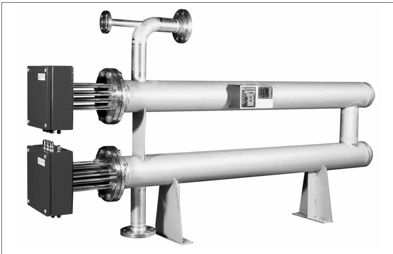
Elektro-Dampfüberhitzer bestehend aus zwei Strömungsrohren mit eingebauten Elektro-Flanschheizkörpern. Betriebsdruck 10 bar (ü). Betriebstemperatur 250 °C. Leistung 160 kW.
